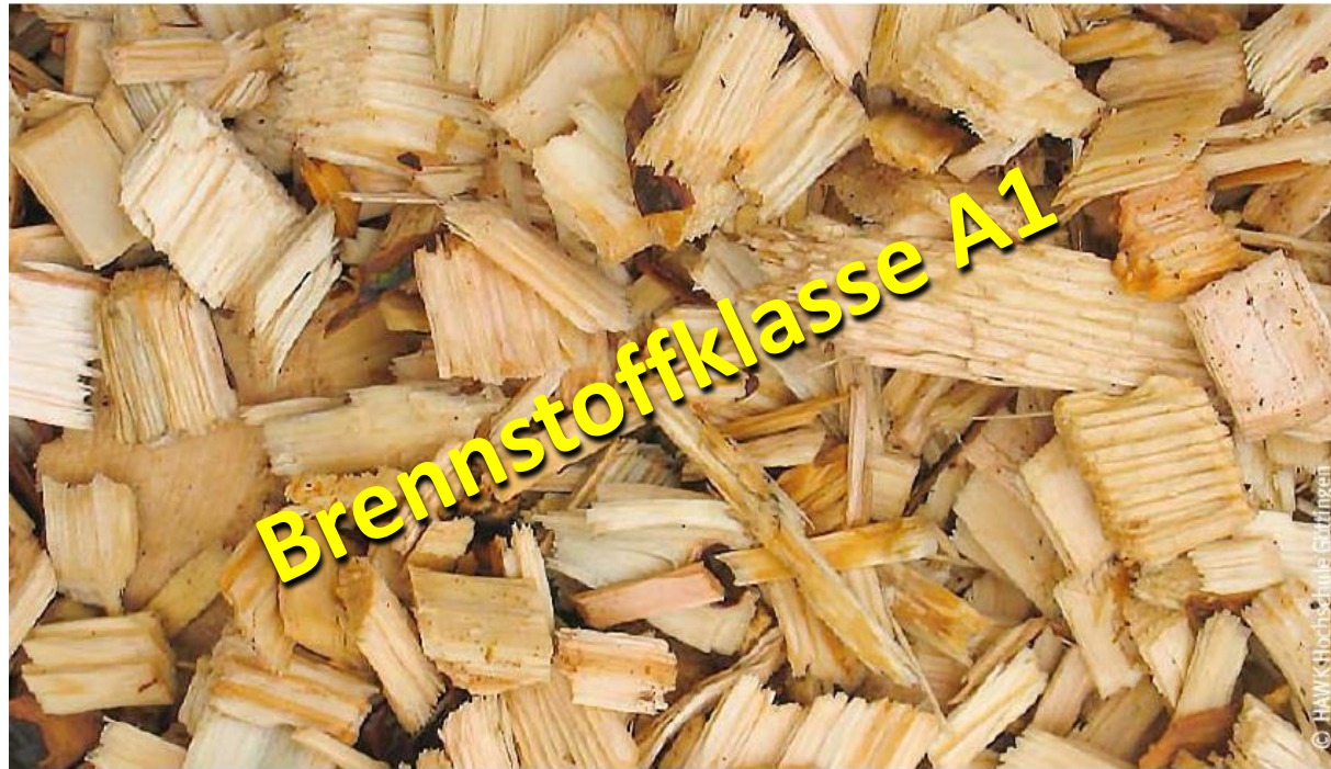
Abb. 1: Hackschnitzel ohne Rinde, Nadeln, Blätter oder feine Äste. Aschegehalt < 1 Masse-%, sehr geringer Feinanteil, Qualität Klasse A1
